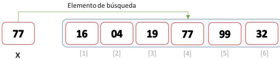
Figura 34. Operación de búsqueda en un vector desordenado
